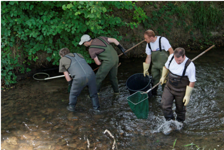
Figure 5 : Pêche électrique réalisée en 2008 sur le site de Verdelot (Couargis), une personne tient l'anode qui délivre le champ électrique, deux personnes ont des électrodes et une personne tient la poubelle dans laquelle sont déposés les poissons capturés, ainsi ils sont protégés du champ électrique diffusé en rivière
