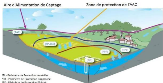
Figure 2 : Schéma de la délimitation d'une aire d'alimentation et des périmètres de protection de captage
